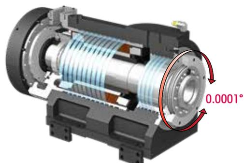
**C轴控制** - 主轴和副主轴均可以用C轴加工, 加工区域扩大, 特别是在使用铣头加工Y轴时可以生产高附加值的产品。
